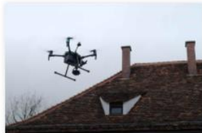
Inspection d'éléments de construction difficiles d'accès à l'aide d'un drone
